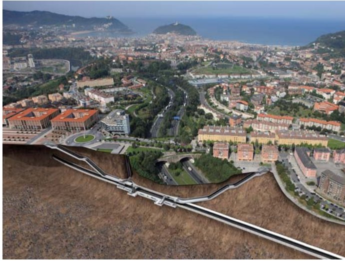
LOIOLA-HERRERA TUNELAREN SEKZIOA SECCIÓN TÚNEL LOIOLA-HERRERA
